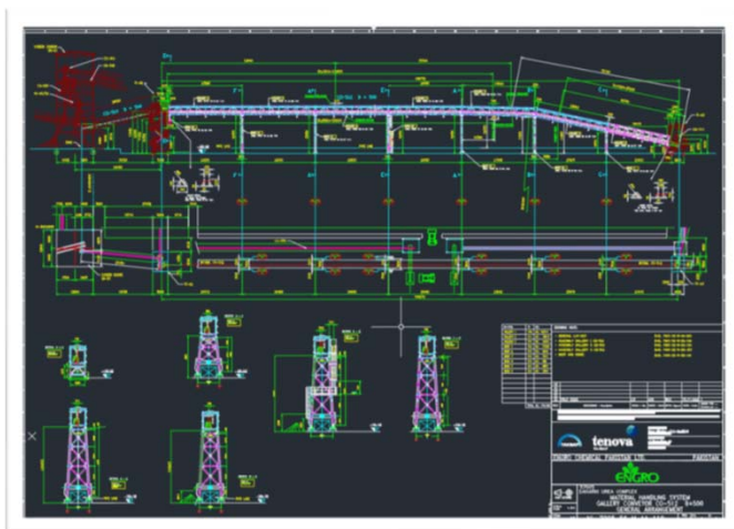
Realizzazione ponte nastro 170 MT, stilate e strutture di trasferimento – Impianto UREA -Pakistan
